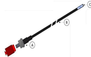
A : Connecteur ; B : Guide optique ; C : Volume de détection de la fibre scintillante
