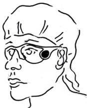
Quelques dosimètres, permettant une mesure directe de  $H_p(3)$  pour les photons et les électrons, sont disponibles. A la date de publication de cette fiche, ils sont tous fondés sur des détecteurs thermo-luminescents de type fluorure de lithium. Ils sont insérés, soit dans un serre-tête élastique, soit dans un boîtier qui s'adapte sur les branches d'une paire de lunettes, sur une visière ou sur un serre-tête. La gamme d'équivalents de dose couverte s'étend le plus souvent de 0,1 mSv à 10 Sv.
