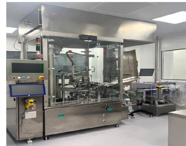
FIG. 2 : Ligne de remplissage de tube ©Pharmacie centrale des armées
