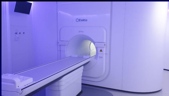
La Résonance embarquée (MR Linac) Champ 1,5 Tesla Faisceau de 7 MV
