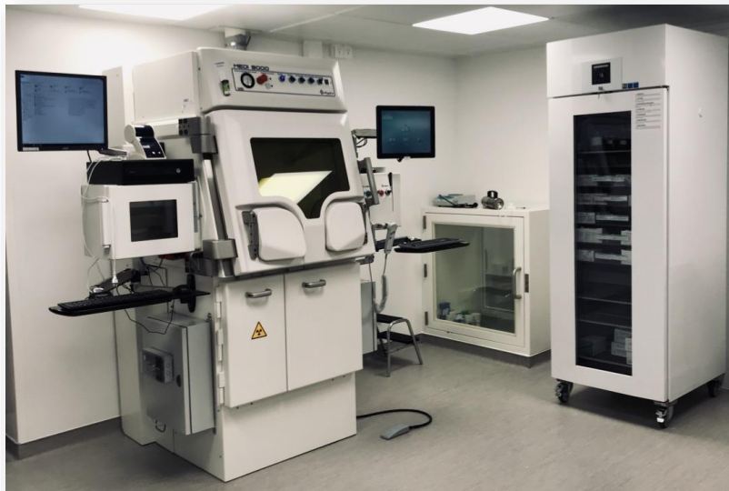
Hotte haute énergie
