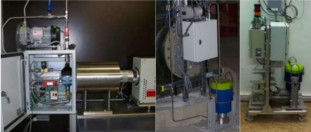
Figure 2: (gauche) spectro cheminée HPGe, (centre) spectro cheminée NaI, (droite) spectro labo NaI
