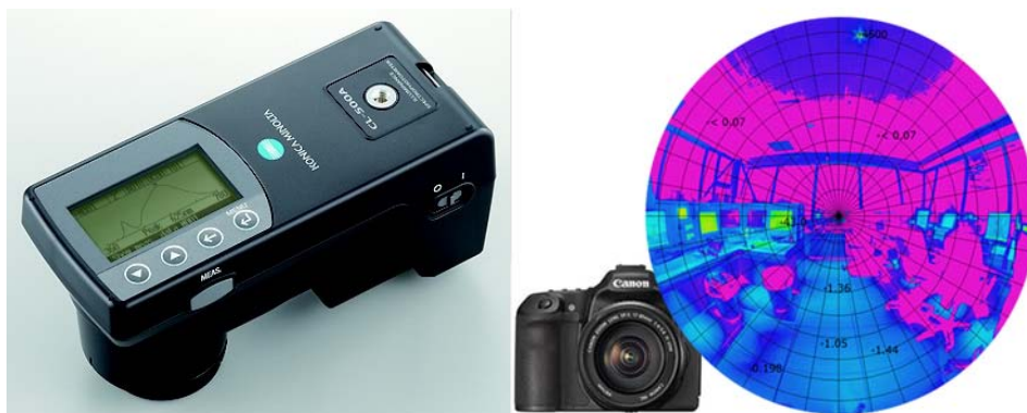
Figure 82 : spectro-photomètre et vidéo-luminancemètre
