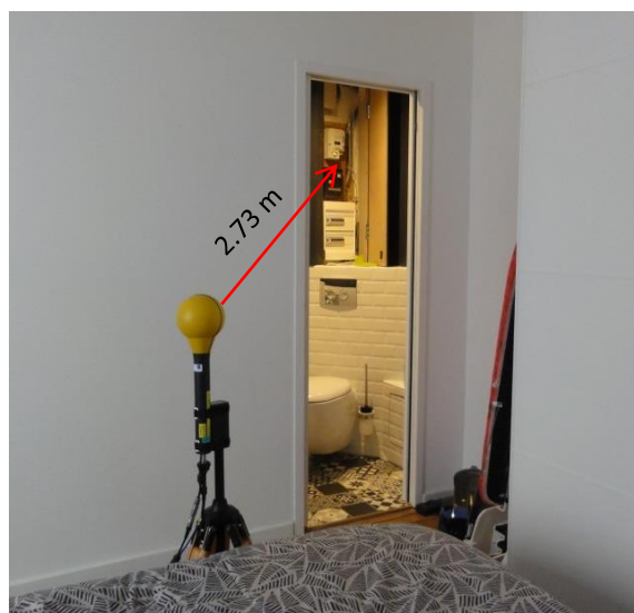
Figure 6 : configuration de la mesure COFRAC réalisé dans l'appartement équipé d'un compteur Linky avec module radio Atome.
