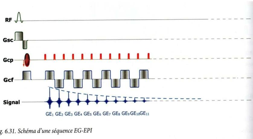
Fig. 6.31. Schéma d'une séquence EG-EPI
