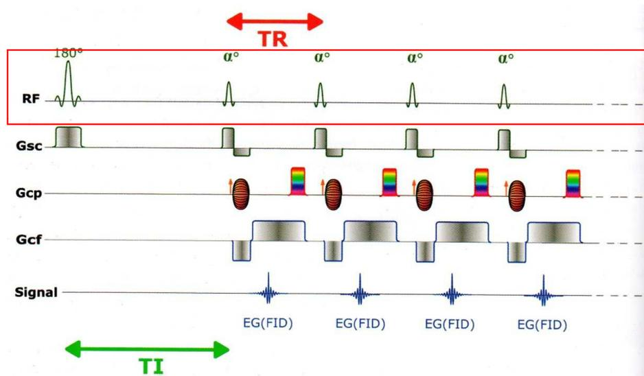
Fig. 6.21. Schéma d'une séquence d'écho de gradient ultra-rapide avec préparation par une impulsion d'inversion
