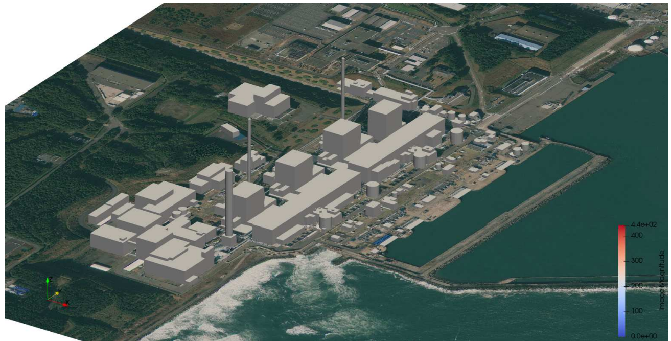
Géométrie pour le calcul CFD
