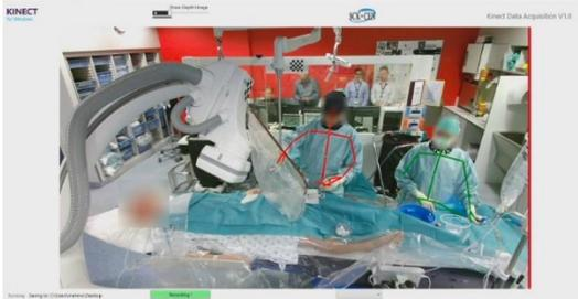
Surveiller la position et les mouvements du personnel avec une caméra 3D et modélisation avec fantômes numériques anthropomorphes flexibles
