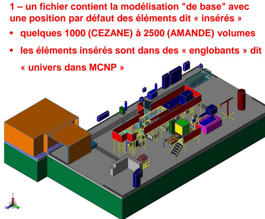
1 – un fichier contient la modélisation "de base" avec une position par défaut des éléments dit « insérés »
