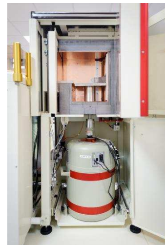
Détecteur gamma Germanium dans son château de plomb
