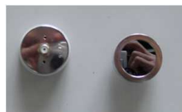
Semi-conducteur seul (à gauche le contact, à droite la surface de détection)
