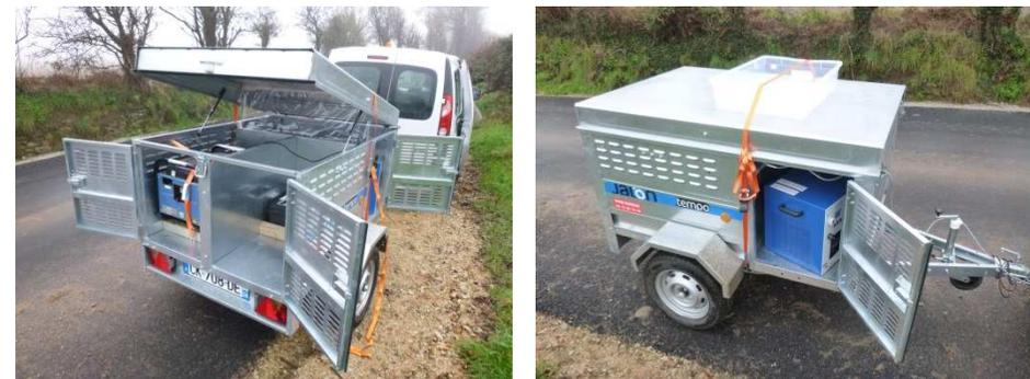
Dispositifs mobiles pour la mesure du  $^{85}\text{Kr}$  dans l'air, et du prélèvement de la vapeur d'eau de l'air et de l'eau de pluie pour la mesure de HTO
