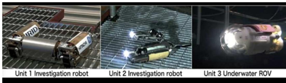
Figure 1. Robots développés pour l'inspection des réacteurs
