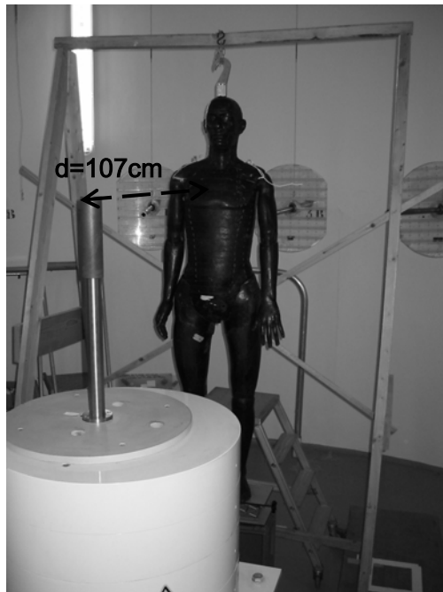
Figure 1 : configuration de l'irradiation d'un mannequin de type RANDO auprès d'une source de photons.
