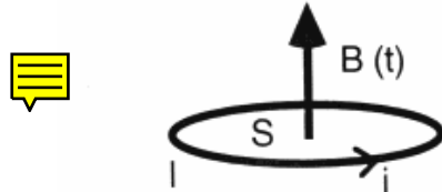
Figure 2. Champ électrique et courants induits dans un milieu conducteur par un champ magnétique
