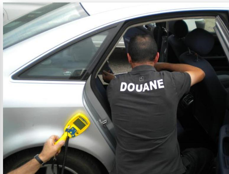
Densimètre pour inspection de corps creux (source scellée Baryum 133)
