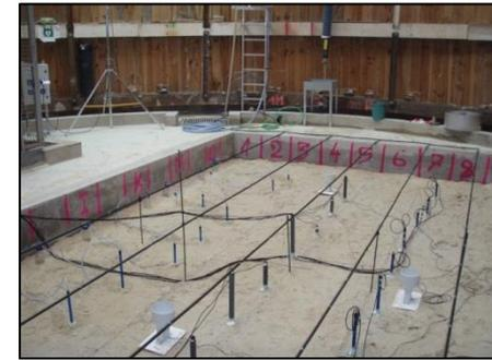
Installation et exploitation d'une station sol (zone non saturée)
