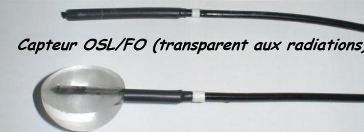
Capteur OSL/FO (avec capuchon en PMMA)
