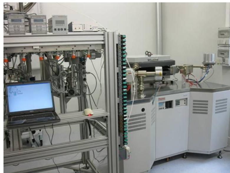
Spectromètre de masse Thermo Scientific HELIX SFT
