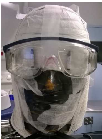
Fantôme tête avec TLD + protection des yeux par lunettes plombées
