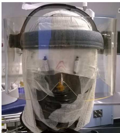
Fantôme tête avec TLD + protection des yeux par visière anti X plombée
