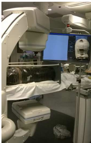
Photo générale du montage : fantôme tête + fantôme buste + écran de scopie latéralisé
