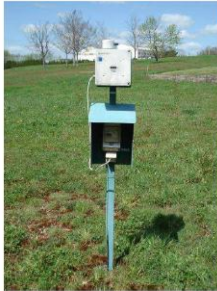
Figure 6 : Une station de mesure pour la surveillance atmosphérique.
