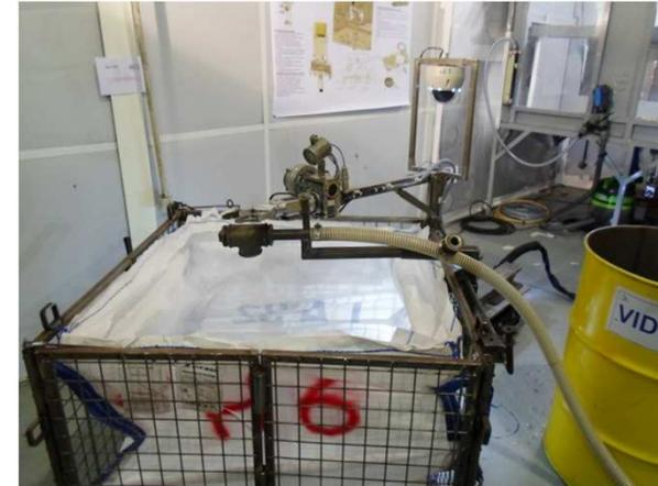
Point d'arrêt : Vérification du bon positionnement de la structure de réception de grenailles à la gamma camera
