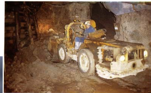
Pelleteuse chargeuse en galerie (cliche COGEMA).
