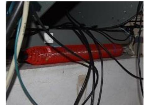
Dosimétrie passive : dosimètre RPL + neutrons le long de la ligne
