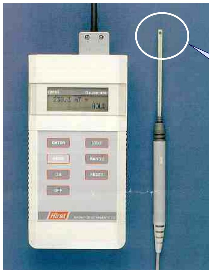
Capteur : taille millimétrique
