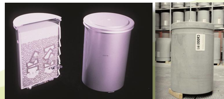
Exemple de colis béton de déchets MA-VL (hauteur : 1 m 50, diamètre : 1 m, poids : ~2 tonnes)
