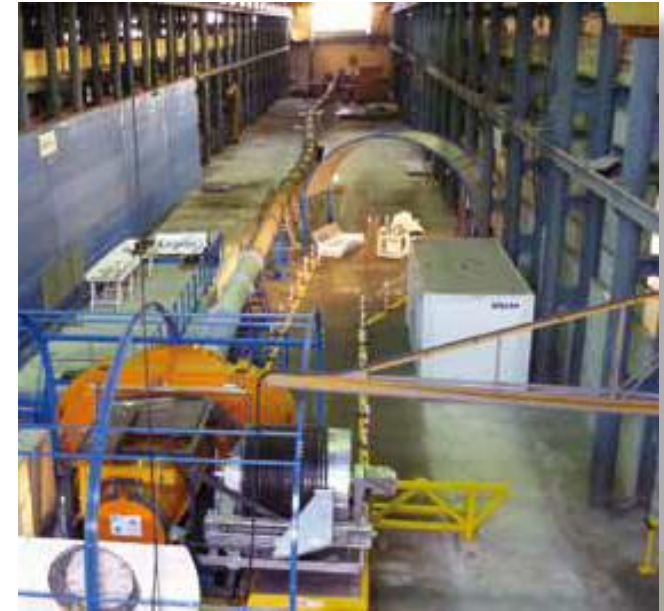
Essais de retrait de colis de déchets dans une alvéole déformée
