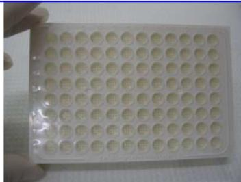
plaques 96 puits Unifilter (filtres absorbants en couche mince)
