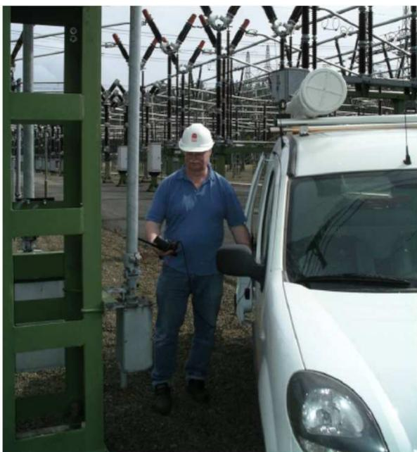
Mesure de courant de contact entre un véhicule et une structure porteuse (poste 400 kV suédois)
