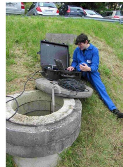
2 sondes de spectrométrie gamma aquatiques (branche Gournay et Maltournée) in situ immergées en continu en deux points de l'entrée des eaux dans l'usine du 31 mai au 26 juillet 2012
