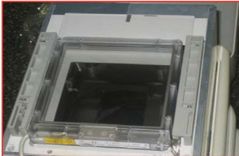
Chambre d'ionisation à transmission (mesure PDS)
