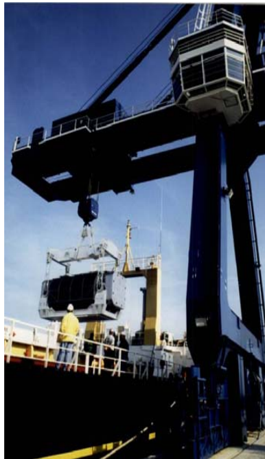
Port de CHERBOURG portique avec flèche articulée pour chargement et déchargement de conteneurs de transport
