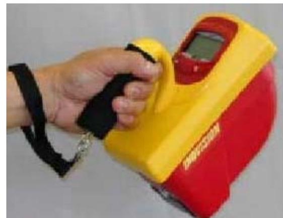
Mesurent les gamma les X et les bêta (plutôt forte énergie)
