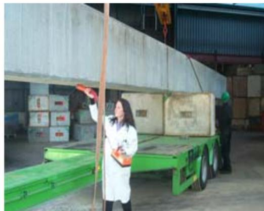
1. Contrôle radiologique des blocs de béton
