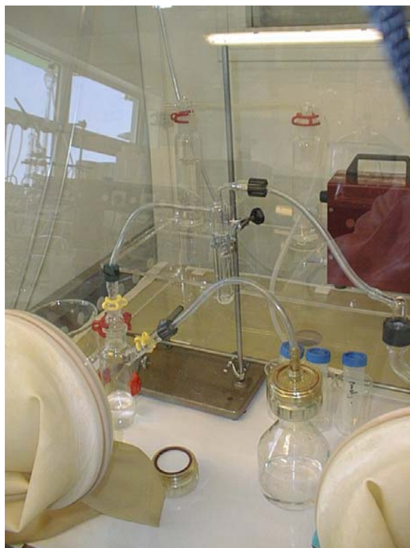
Piégeage de \text{CO}_2 et précipitation de \text{BaCO}_3
