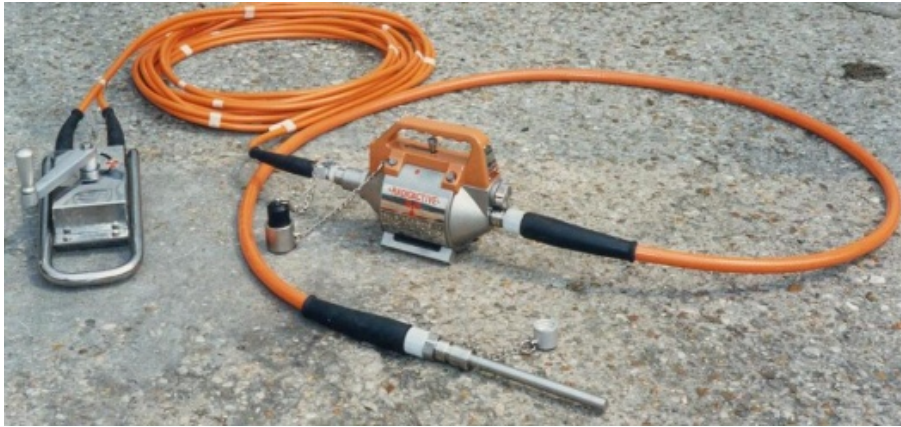
Appareil de gammagraphie et ses accessoires (télécommande, gaine d'éjection, embout d'irradiation)
